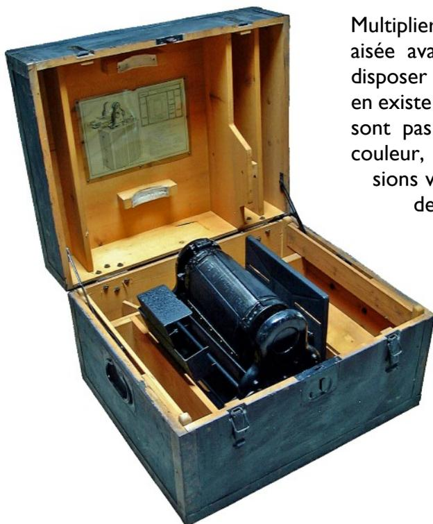
Multiplier les notes de cours n'est pas une tâche aisée avant l'arrivée des photocopieurs. Il faut disposer pour cela d'une machine à polycopier. Il en existe qui utilisent des stencils à alcool. Elles ne sont pas trop chères et peuvent imprimer en couleur, mais elles ne permettent pas d'impressions volumineuses. Pour cela, il faut employer des stencils à encre et recourir à des machines plus grosses, plus professionnelles, plus onéreuses.
