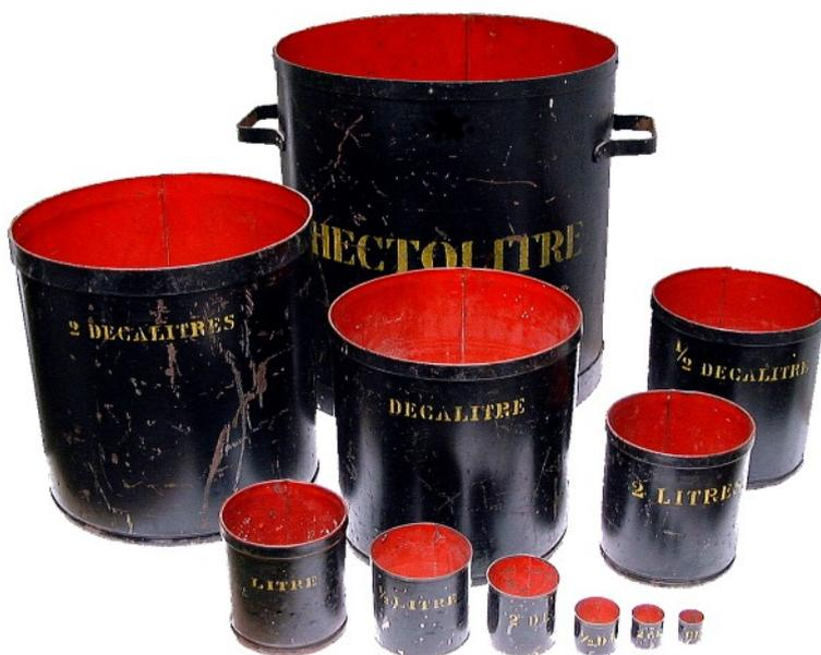
Ces récipients cylindriques en tôle peinte sont utilisés pour mesurer les liquides, mais aussi les solides en grain. Ils s'emboîtent aisément (et logiquement) les uns dans les autres pour faciliter le transport. À cet effet, le récipient le plus grand est muni de poignées.
