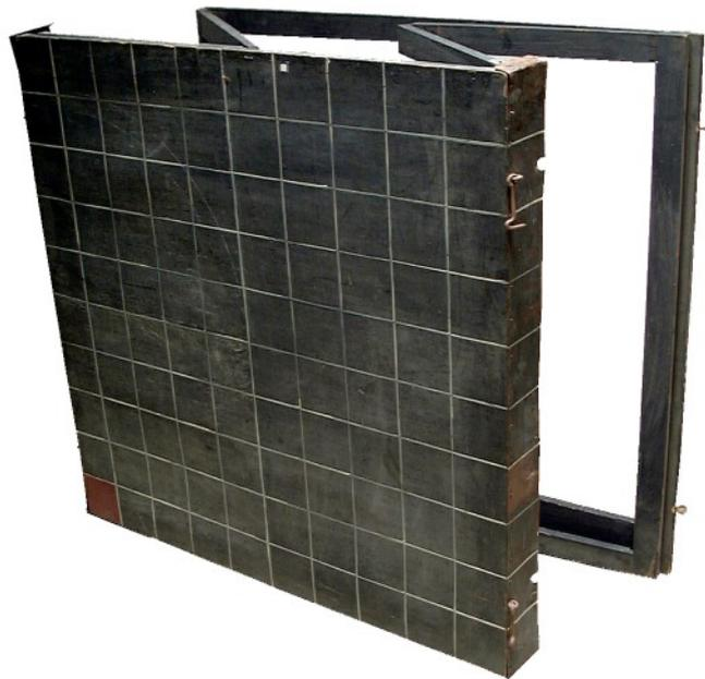
Cet objet repliable donne aux élèves une perception intuitive du mètre (et du décimètre par le quadrillage), du mètre carré et du mètre cube (lorsqu'il est déplié).
