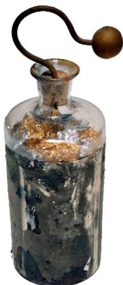
deux conducteurs séparés par le verre de la bouteille. Le premier est une électrode reliée à des feuilles d'étain chiffonnées. Le deuxième est la pellicule métallique qui enveloppe la bouteille.
