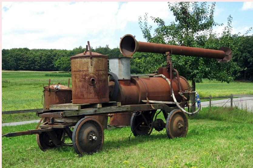
*Les machines à vapeur agricoles sont mobiles. Tirées par des chevaux ou des bœufs, elles sont amenées dans les champs selon les besoins. Ces machines sont dotées d'une roue latérale sur laquelle s'enroule une longue courroie qui entraîne d'autres machines.*
